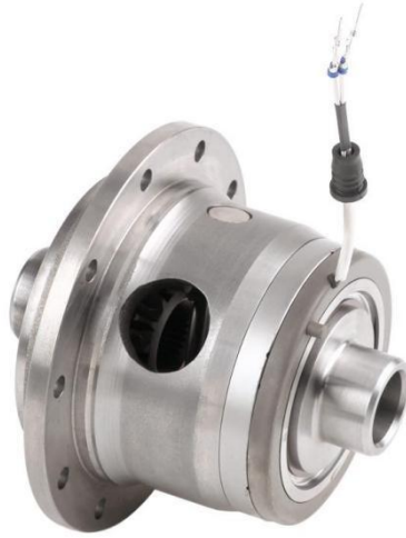
Рисунок 1.4 – Електромагнітний диференціал блокування
