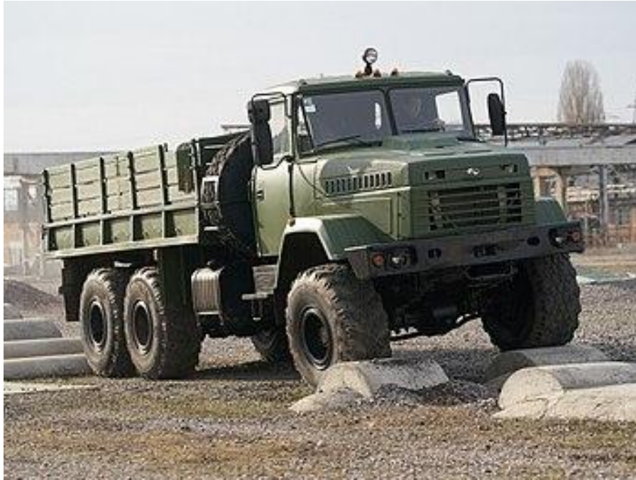
Рисунок 2.9 – Випробування надійності автомобіля КрАЗ
