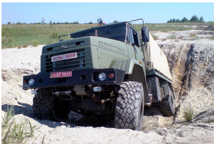
Рисунок 2.7 – Випробування прохідності автомобіля КрАЗ
