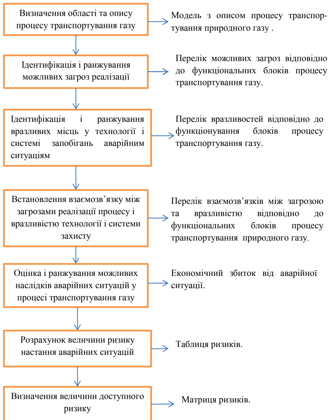
Рис.3.4.3. Алгоритм оцінювання екологічних ризиків процесу транспортування природного газу трубопроводом
