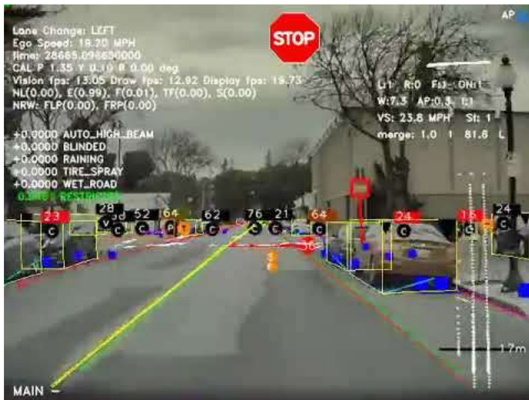
Рисунок 2.6 – Як автомобіль компанії Tesla використовуючи камери із технологією комп'ютерного зору разом з НМ розпізнає об'єкти [26]
