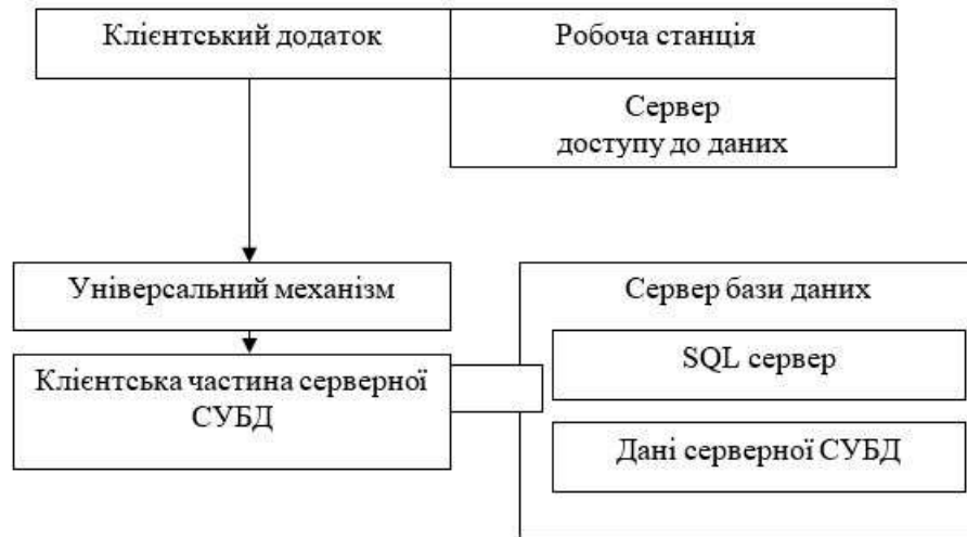
Рисунок 2.3 – Схема організації зв'язку між клієнтською та серверною частинами
