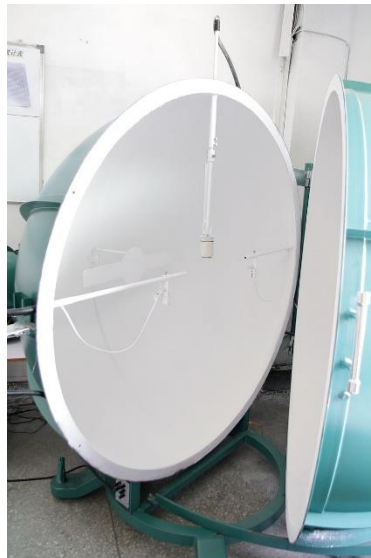
Рисунок 5.2 – Прилад для вимірювання світлового потоку
