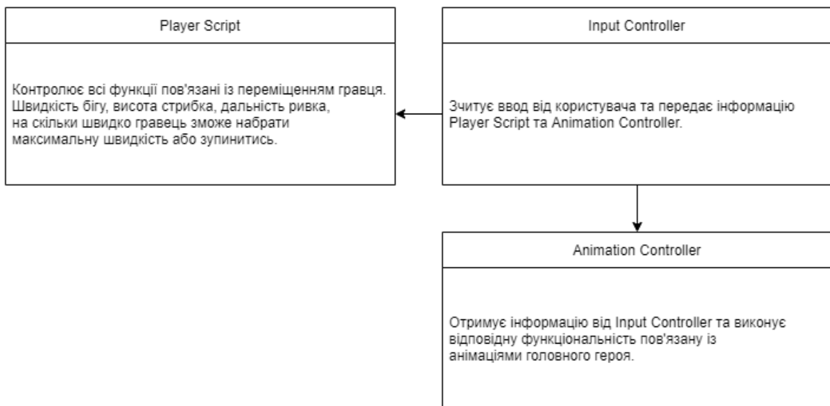
Рисунок 2.2 - Схема зв'язків між класами
