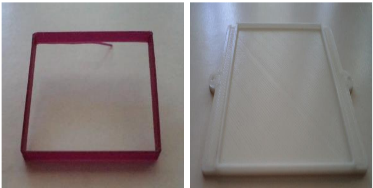
Рисунок 3.12 – Корпус осцилографа, що надруковано 3D принтером. А - XYZ та Б - МПС принципами переміщення робочого органу.
