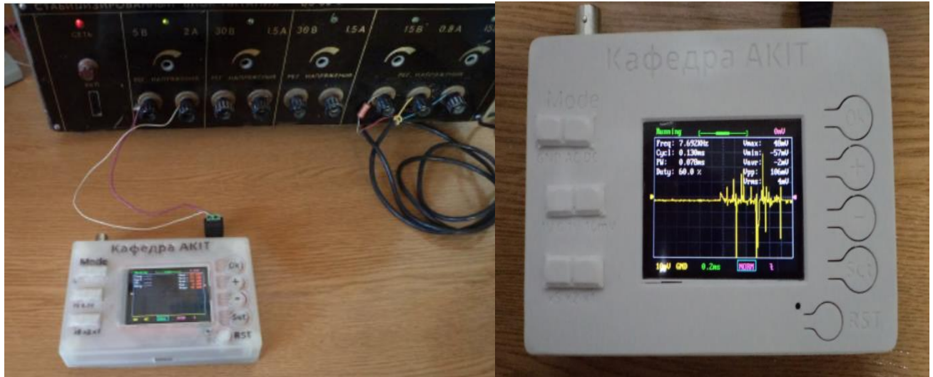
Рисунок 3.12 – Корпус осцилографа, що надруковано 3D принтером. А - XYZ та Б - МПС принципами переміщення робочого органу.
