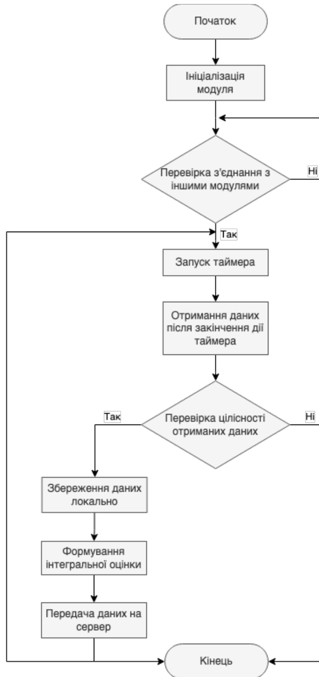
Рисунок 2.3.3 - Алгоритм синхронізації, аналізу, стиснення та передачі даних на сервер через координатор
