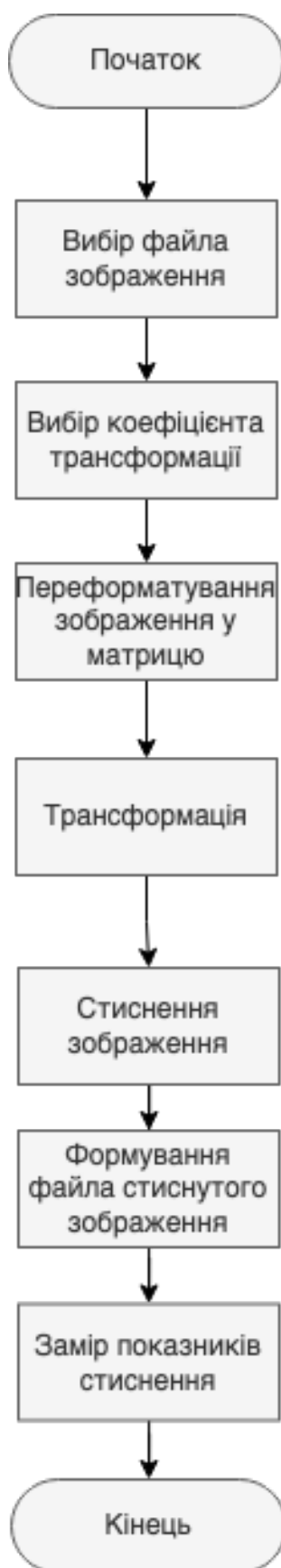
Рисунок 3.3.5 - Алгоритм роботи скрипта компресії зображення на основі DWaT
