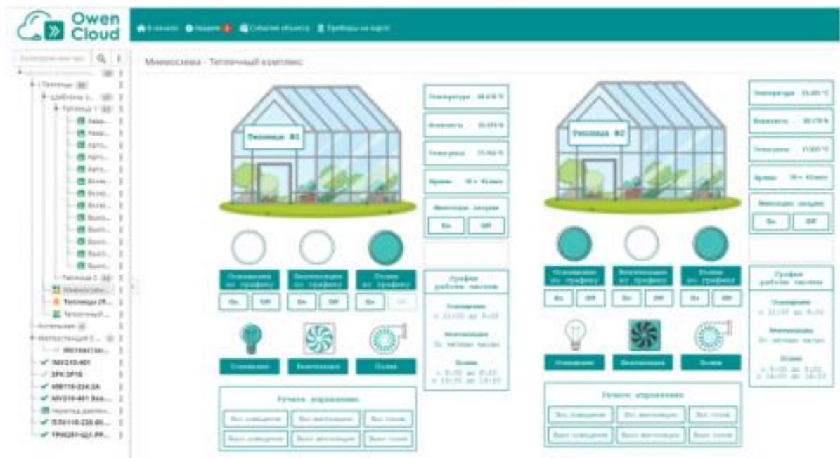
Рисунок 2.15 - Мнемосхема для моніторингу і керування на прикладі теплиці
