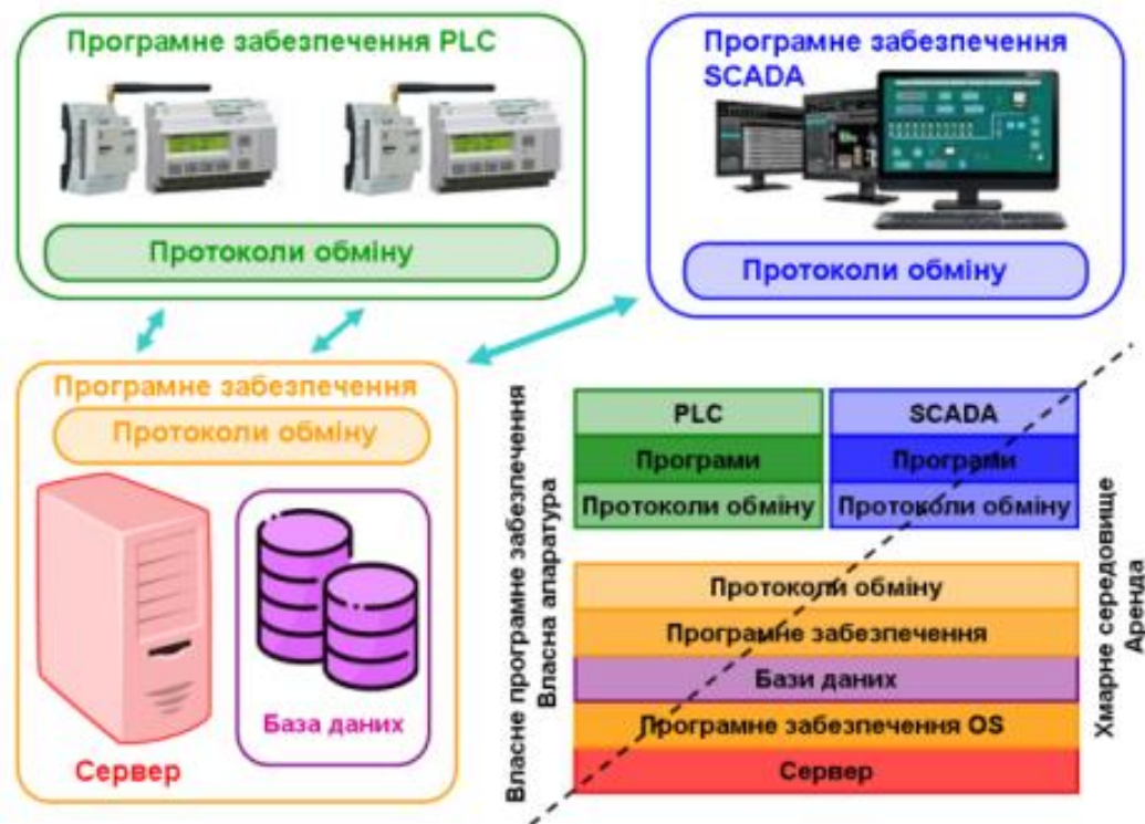
Рисунок 2.10 – Архітектура апаратного та програмного забезпечення інформаційної мережі
