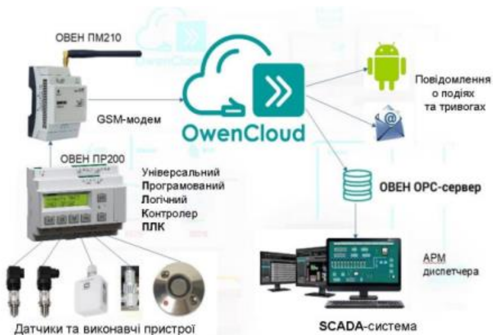
Рисунок 2.10 – Система диспетчеризації на базі промислових ПЛК та “хмарного” середовищ
