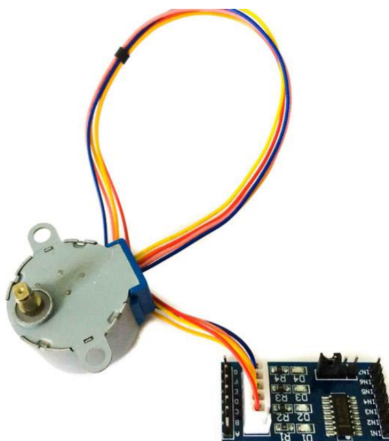
Рисунок 2.26 – З'єднання крокового двигуна і драйвера [42]
