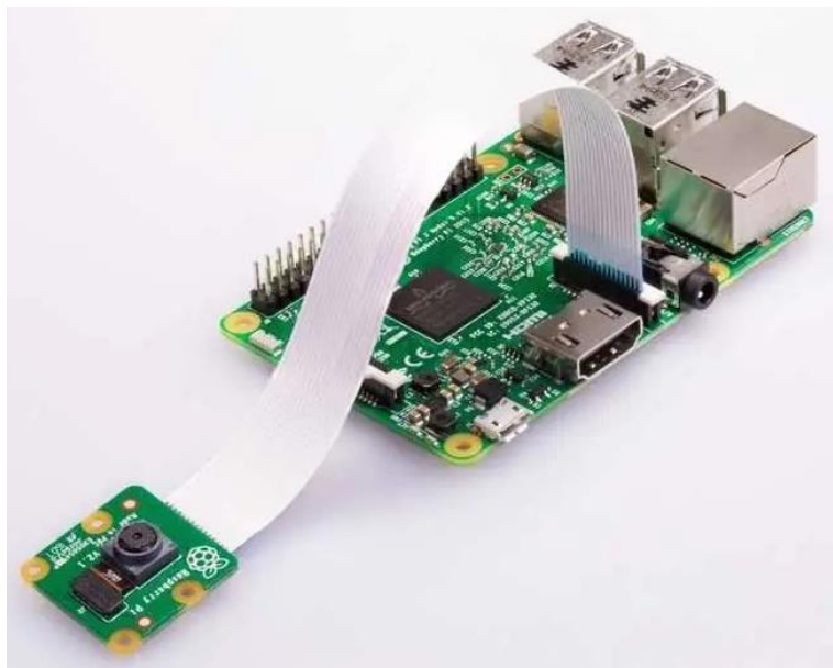
Рисунок 2.8 Підключення модуля камери до Raspberry Pi
