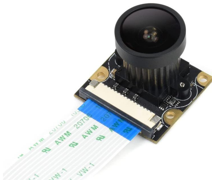
Рисунок 1.5 - Waveshare IMX477-160 12.3MP Camera
