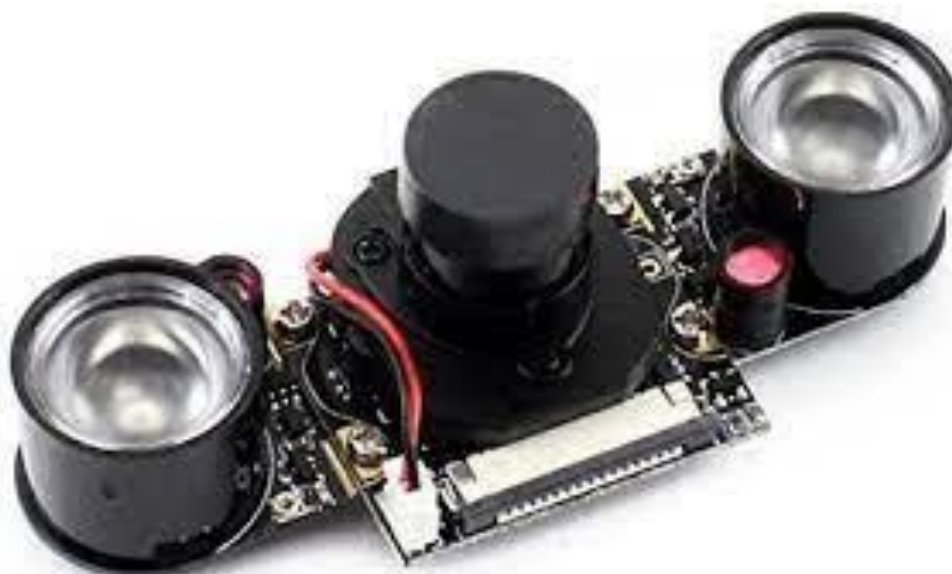
Рисунок 1.7 - Waveshare IMX219-83 Stereo Camera
