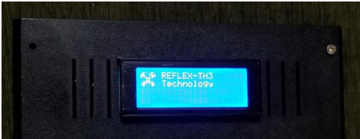
Рисунок 4.1 – LCD-екран на корпусі тренувального приладу «Reflex – TH3»
