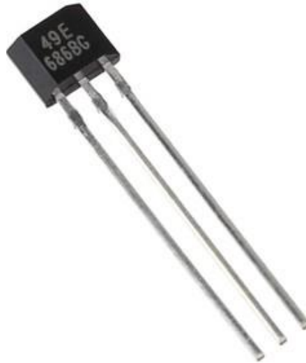
Рисунок 1.5 – Електронний компонент датчика Холла
