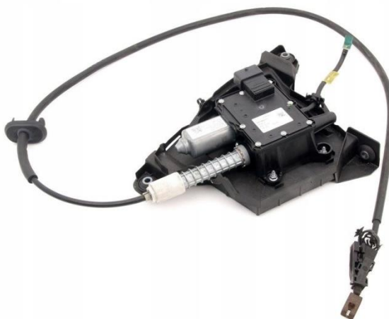
Рисунок 2.11 – серводвигун стоянкового гальма
