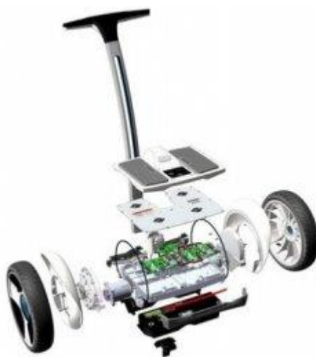
Рисунок 1.3 – Структура схема сегвея
