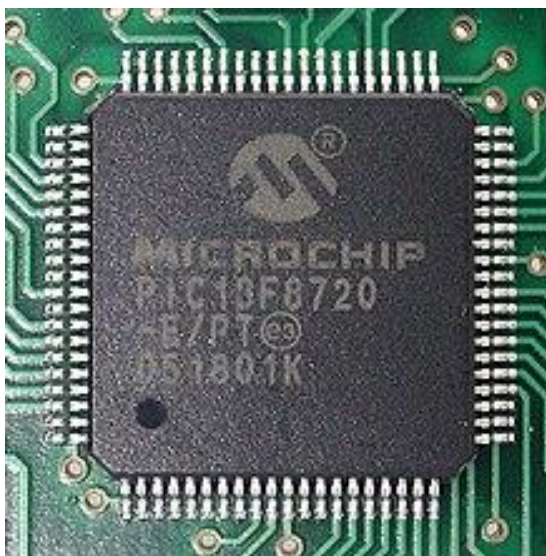
Рисунок 1.1 - Мікроконтролер PIC 18F8720 у 80-контактному корпусі TQFP
