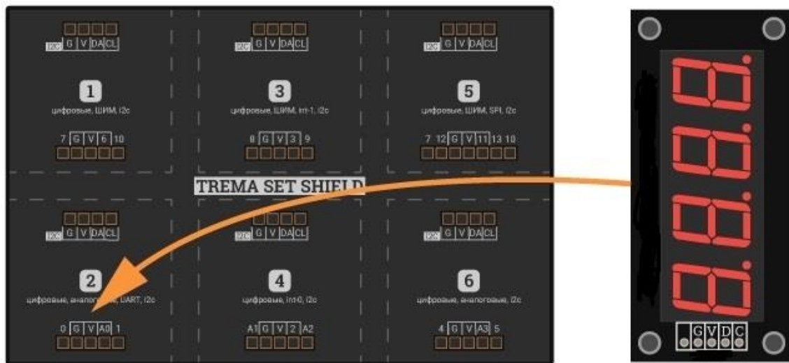
Рисунок 1.3.1 – Встановлення чотирьохрозрядного індикатора
