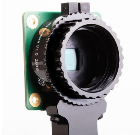
Рис. 1.13 – Pi High Quality Camera без об'єктиву
