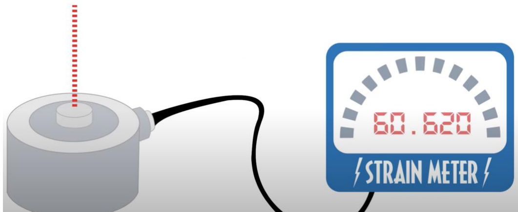
Рисунок 4.8 – Робота тензодатчику. При натисканні відображається значення у цифрах
