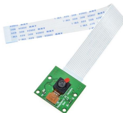
Рисунок 2.5 – Зовнішній вигляд Raspberry Pi 5mp
