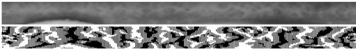
Рисунок 3.4 – Нормалізоване зображення райдужної оболонки – зверху і остаточне код райдужної оболонки ока – внизу.
