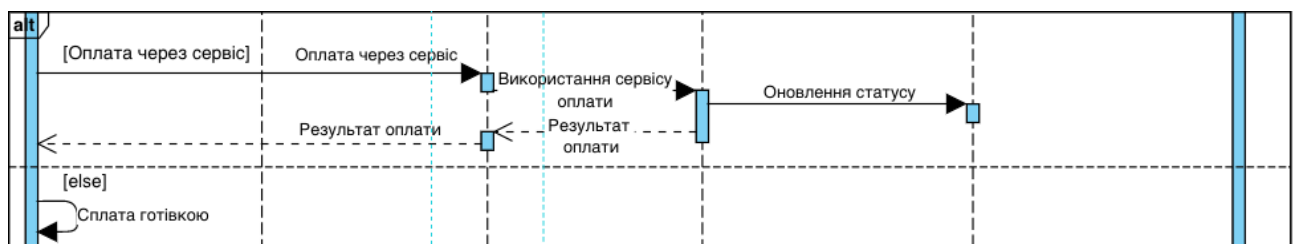
Рисунок 2.11 – Операнд Alt з вибором клієнт
