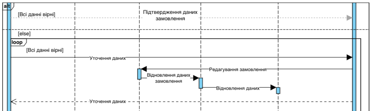
Рисунок 2.10 – Операнд Alt з використанням операнду loop
