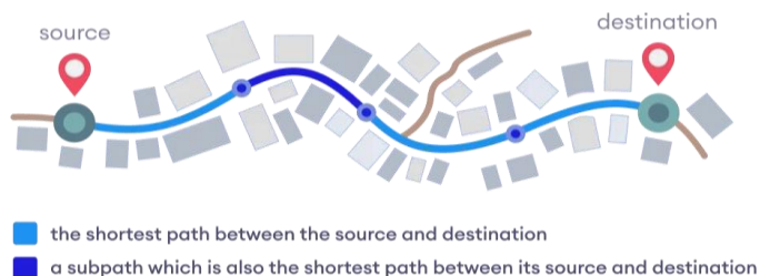
Рисунок 2.10 – Принцип роботи алгоритму Дейкстри
