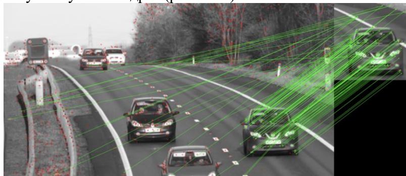
Рисунок 4.31 – Результат визначення зміни положення об'єкта машини відносно якої проводяться виміри швидкості на ділянці дороги в точці А
