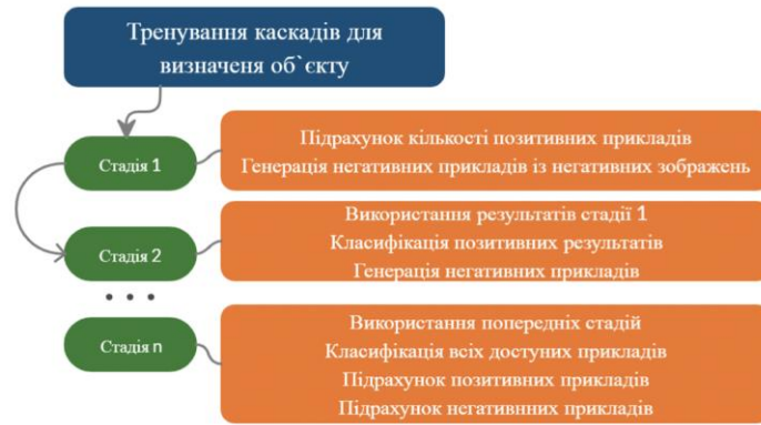
Рисунок 2.8 – Схема навчання каскадів
