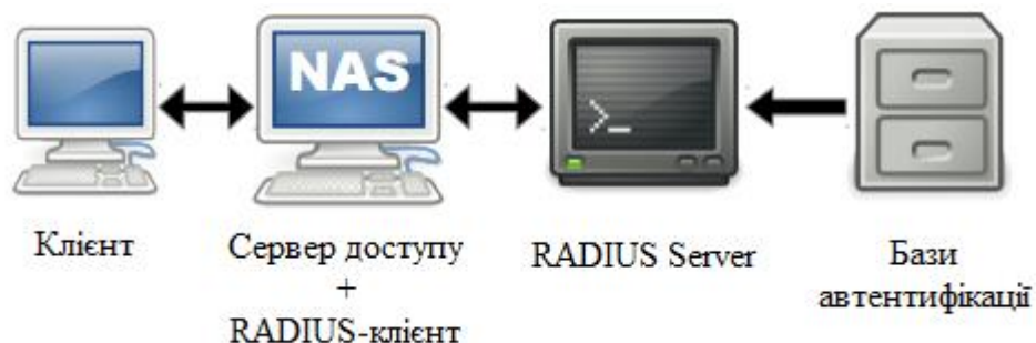
Рисунок 1.3 – Структура мережі з RADIUS сервером
