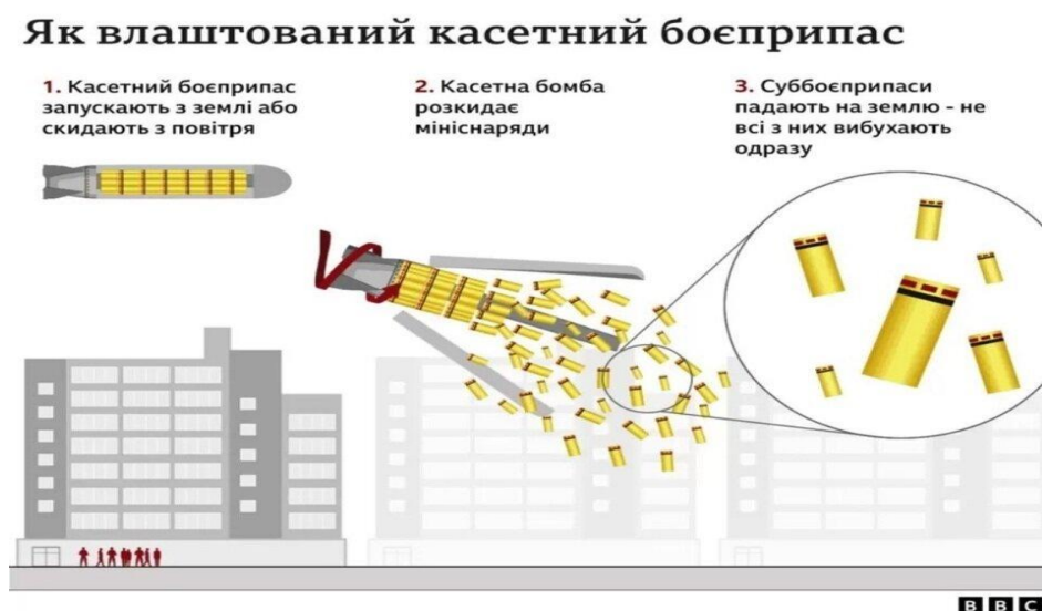
Рис. 3.10 Устрій касетного боеприпасу
