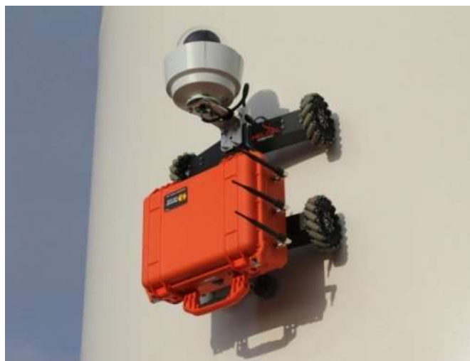
Рисунок 1.12 – Робот-верхолаз HR-MP для діагностики конструкцій турбін вітрогенераторів
