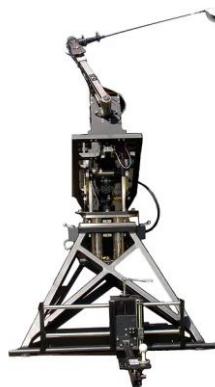
Рисунок 2.19 – Робот для створення ударів у гольфі
