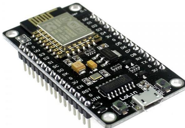
Рисунок 3.1 – Зовнішній вигляд плати LoLin NodeMCU v3 ESP8266
