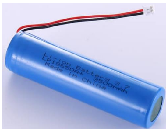
Рисунок 3.5 – Літій-іонна батарейка для живлення плати
