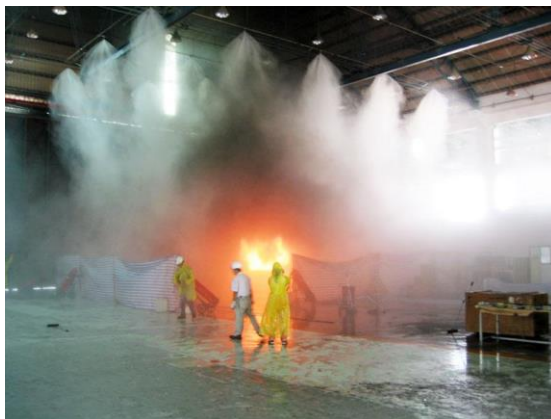
Рисунок 1.3 – Система придушення пожежі водою
