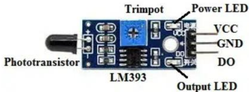
Рис. 2.2. - Схема контактів датчика
