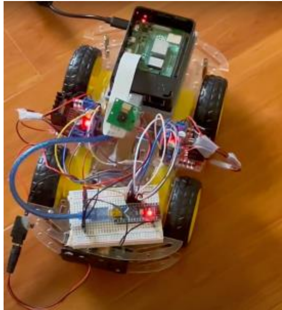
Рисунок 1.5 – Програмування слідкуючого робота за допомогою Raspberry Pi
