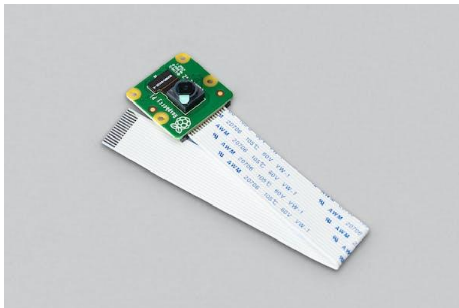
Рисунок 2.3 – RasPi cam V2
