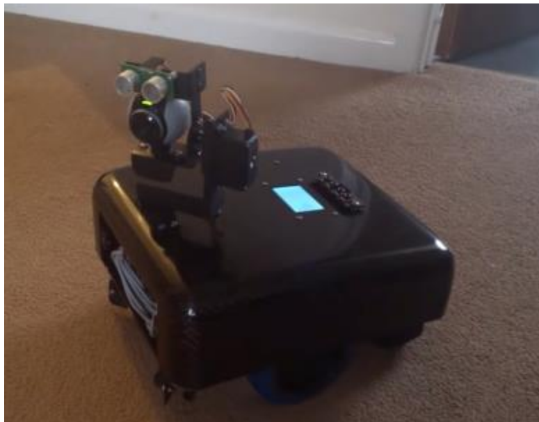
Рисунок 1.7 – Робот для виявлення перешкод
