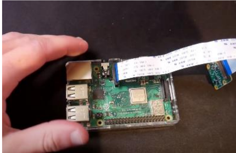
Рисунок 4.9 – Підключення шлейфу камери до плати
