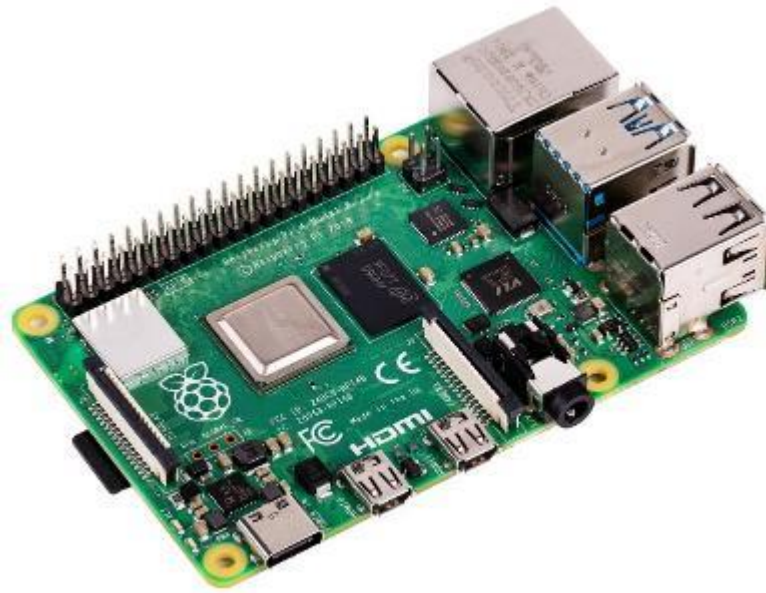
Рисунок 2.1 – Одноплатний комп'ютер Raspberry Pi 4 Model B
