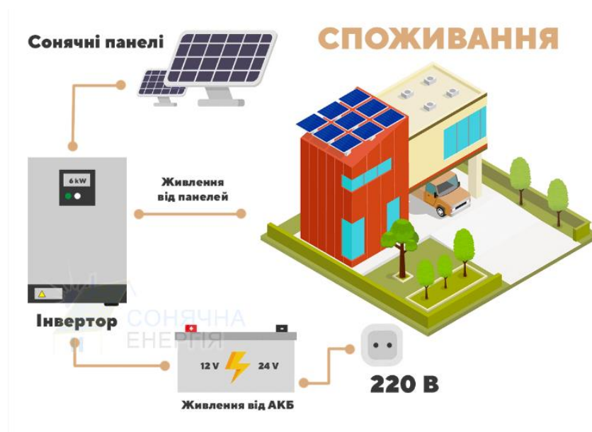
Рис. 1.1 – Схема домашньої сонячної електростанції.
