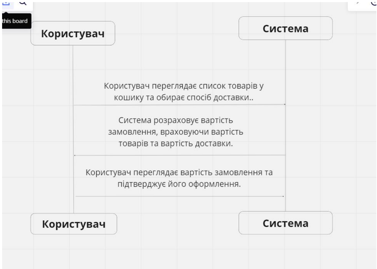
Рисунок 2.2 – Діаграма послідовності «Розрахунок вартості замовлення»
