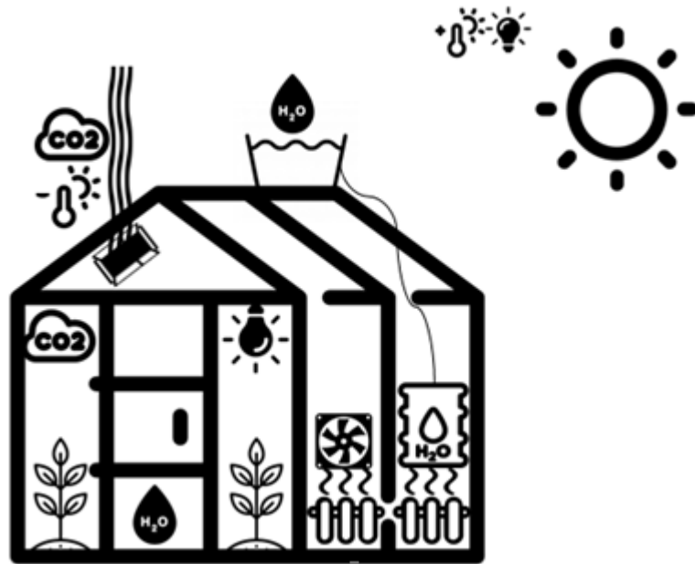
Рисунок 2.1 - Структурна схема системи керування мікрокліматом
