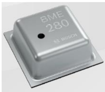
Рисунок 2.5 - Мікродатчик температури, вологості і тиску BME280 [13]
