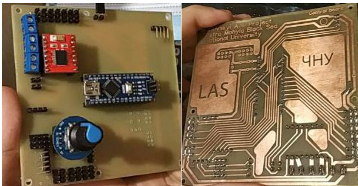
а) б) Рисунок 3.7 – Зовнішній вигляд витравленої плати: а - сторона з елементами; б - друкована сторона;
