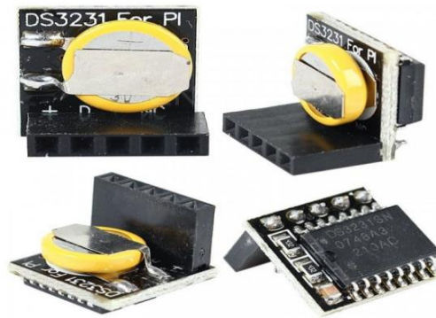
Рисунок 2.9 - Модуль реального часу DS3231 [17]
