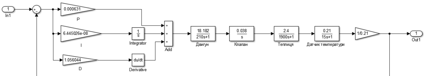
Рисунок 4.12 - Структурна схема для побудови годографа Найквіста по каналу регулювання температури
