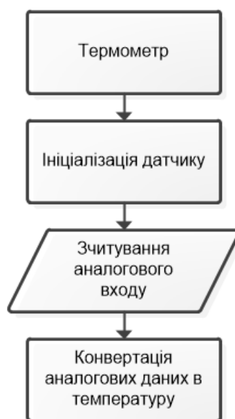
Рисунок 3.15 – Блок-схема алгоритму роботи термометру
