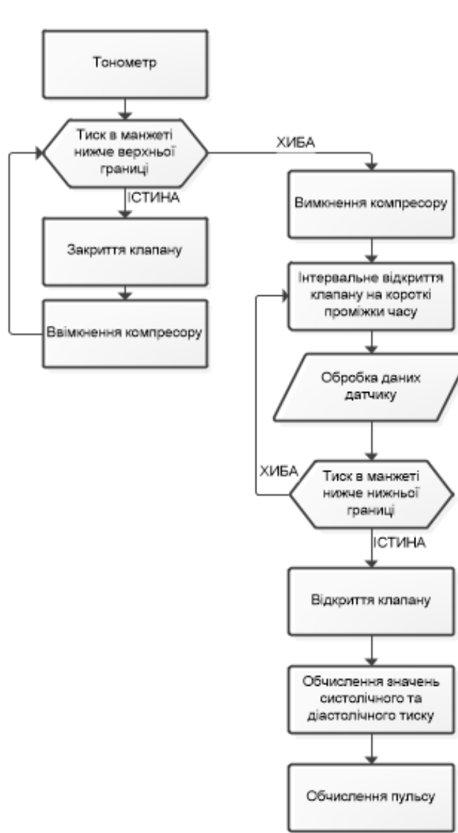
Рисунок 3.16 – Блок-схема алгоритму роботи тонометру
