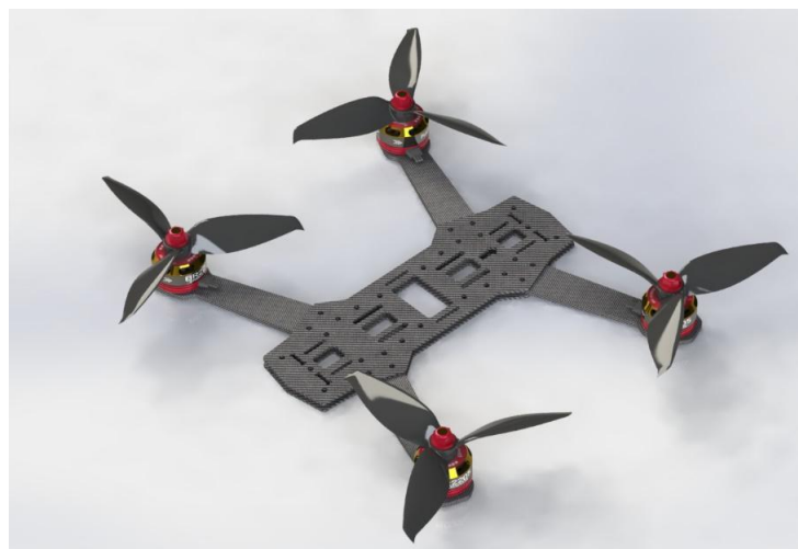
Рисунок 3.1 – Візуалізація тривимірної моделі квадрокоптера у CAD-системі Solid Works
