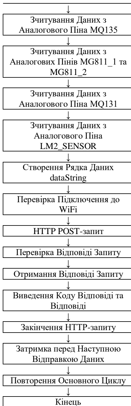
Рис 3.1.1 Алгоритм роботи скетчу, що збирає та пересилає дані датчиків У циклі loop() значення зчитуються з датчиків, формуються в рядок даних, відправляються на сервер, а потім виконується затримка перед наступною ітерацією. Цикл повторюється постійно, збираючи та відправляючи дані з датчиків.
