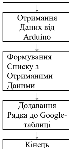
Рис 3.1.2 Алгоритм роботи програми, що приймає дані та заносить до таблиці
