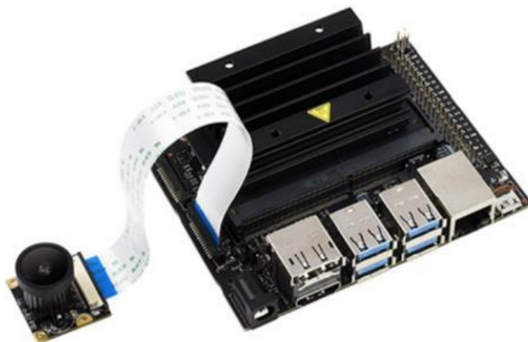
Рисунок 2.10 – Підключення відеокамери IMX477-160 12.3MP до одноплатного комп'ютера Jetson Nano Developer Kit
