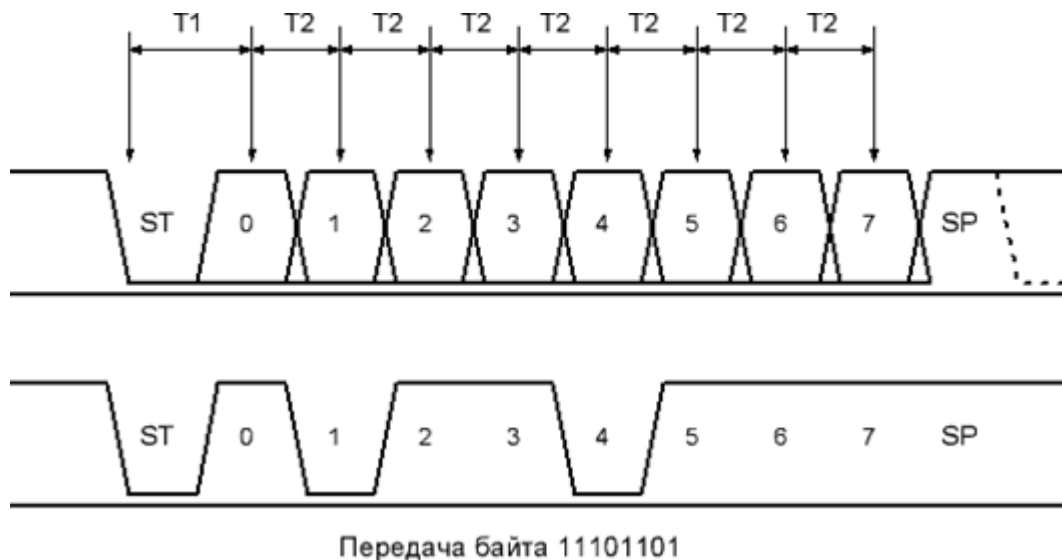
Рисунок 3.11 – Протокол передачі фрейму UART
