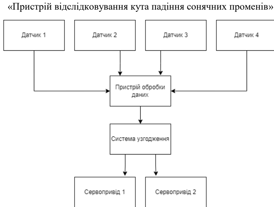
Рисунок 2.2 – Структурна схема пристрою
