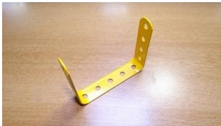
Рисунок 3.11 – Зігнута металева смуга для другого сервоприводу
