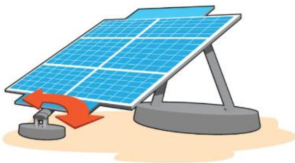
Рисунок 1.10 – Зображення одноосьового трекеру з вертикальною віссю обертання
