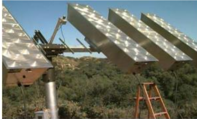
Рисунок 1.5 – Конструкція сонячної електростанції з застосуванням плоских лінз Френеля
