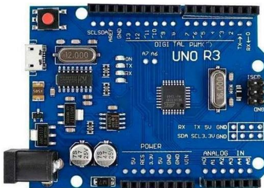
Рисунок 2.3 – Зображення обраного мікроконтролера Arduino Uno R3
