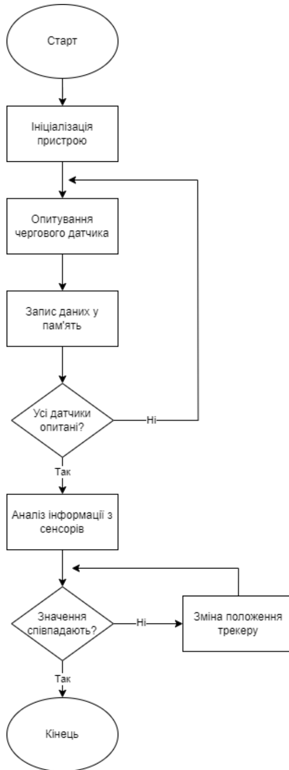
Рисунок Б.1 – Блок-схема алгоритму роботи пристрою
