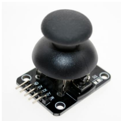
Рисунок 3.11 – Модуль джойстика PS2
