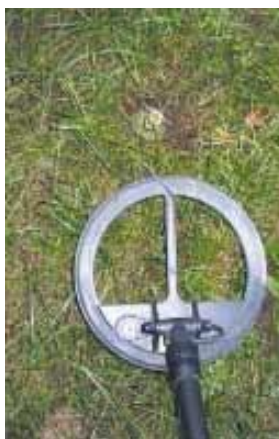
Малюнок 2.5 – Пошукова головка Guartel MD8 з осколковою міною
