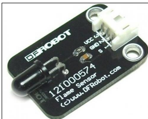
Рисунок 3.3 – Сенсор вогню від DFRobot
