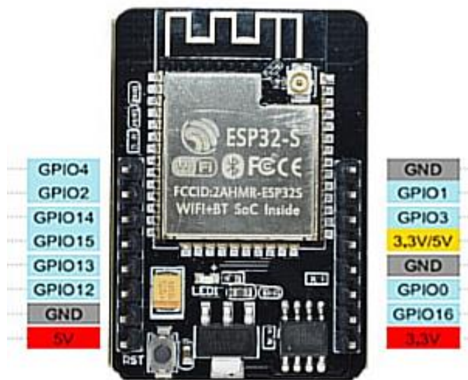
Рисунок 3.5 – Розміщення пінів ESP32-CAM
