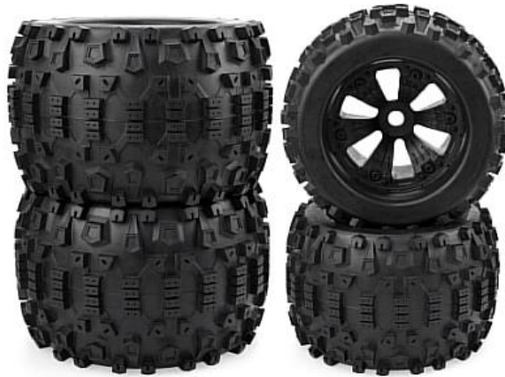
Рисунок 1.10 – Колеса для бездоріжжя з грубим протектором
