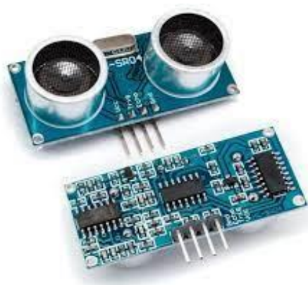
Рисунок 2.1 – Ультразвуковий дальномір HC-SR04
