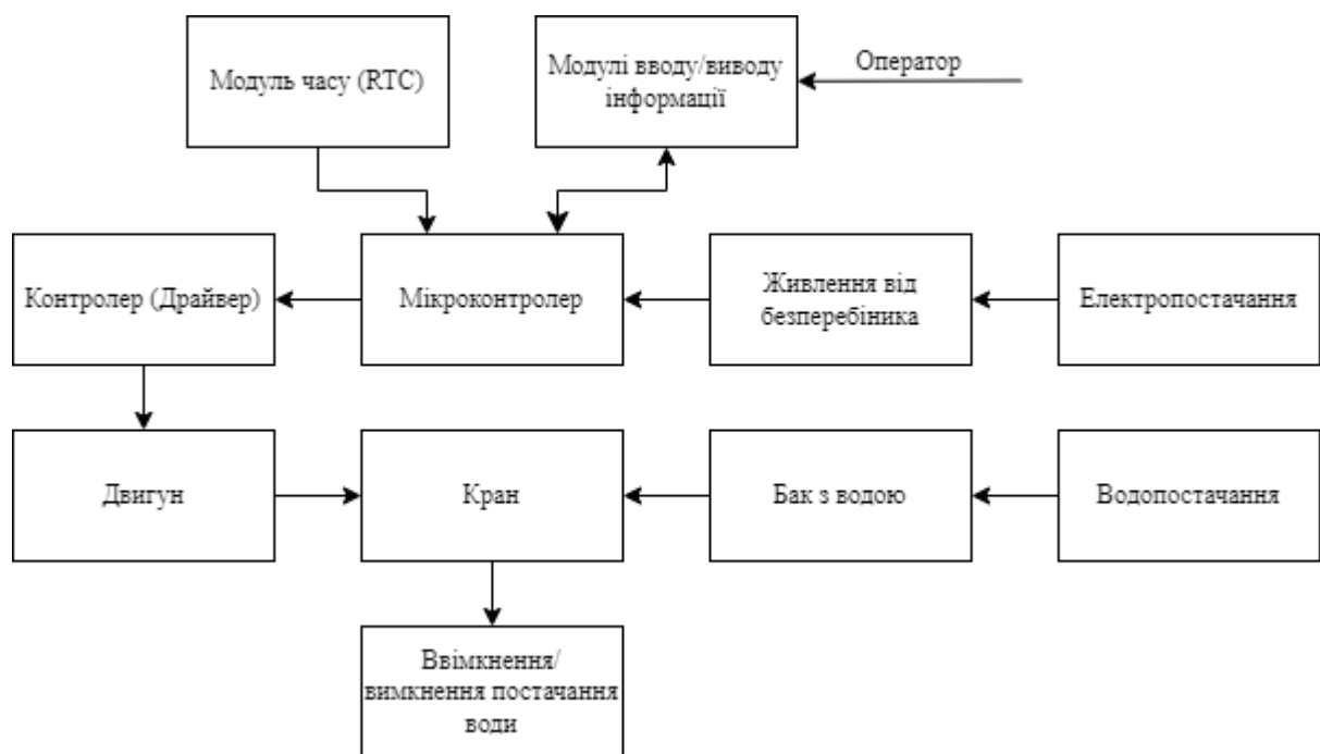
Рисунок 2.1 – Функціональна схема системи поливу
