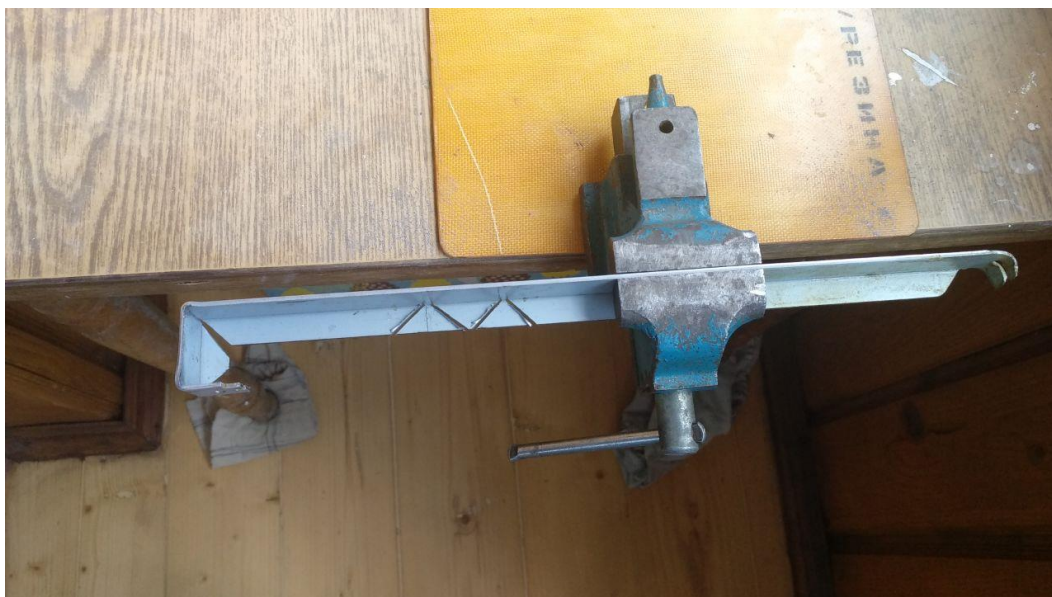
Рисунок 2.13 – Фіксація металевого кута для випилки форми
