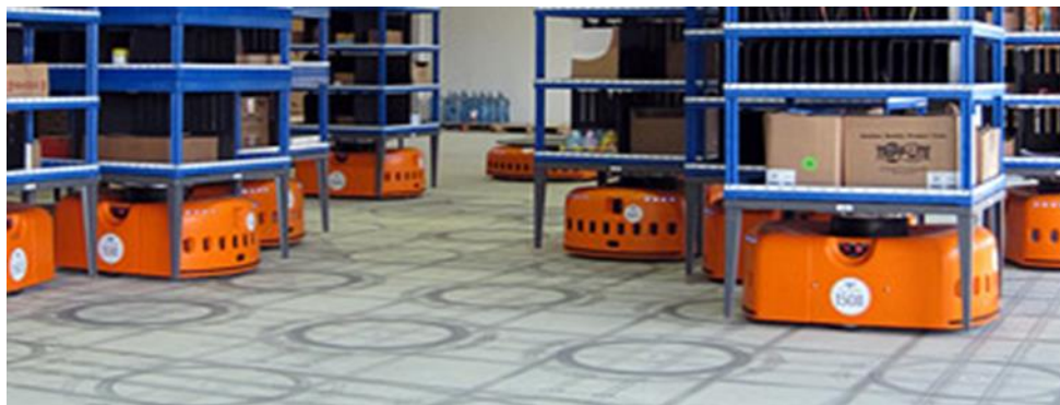
Рисунок 1.1 – Робот Kiva System, що виконує завдання на складах з виробами
