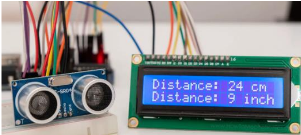
Рисунок 2.22 – HC-SR04 Ultrasonic Sensor у дії на основі плати «Ардуіно»
