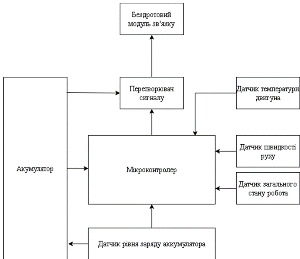
Рисунок 2.18 – Функціональна схема моніторингу за станом робота
