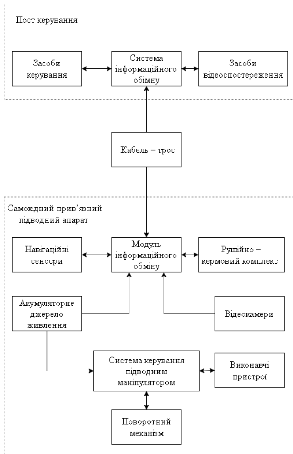
Рисунок 2.1.2 – Функціональна блок – схема ППС на базі СППА при використанні підводного маніпулятора
