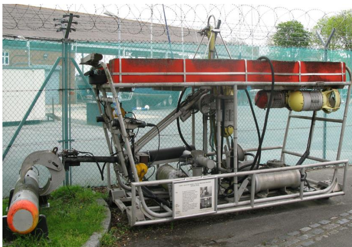
Рисунок 1.1.1 – ДКПА Королівського флоту (Cutlet), вперше використаний у 1950-х роках для вилучення тренувальних торпед і мін
