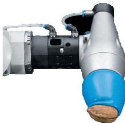
Рисунок 1.3.2 – Захватний пристрій поверхневого натягу
