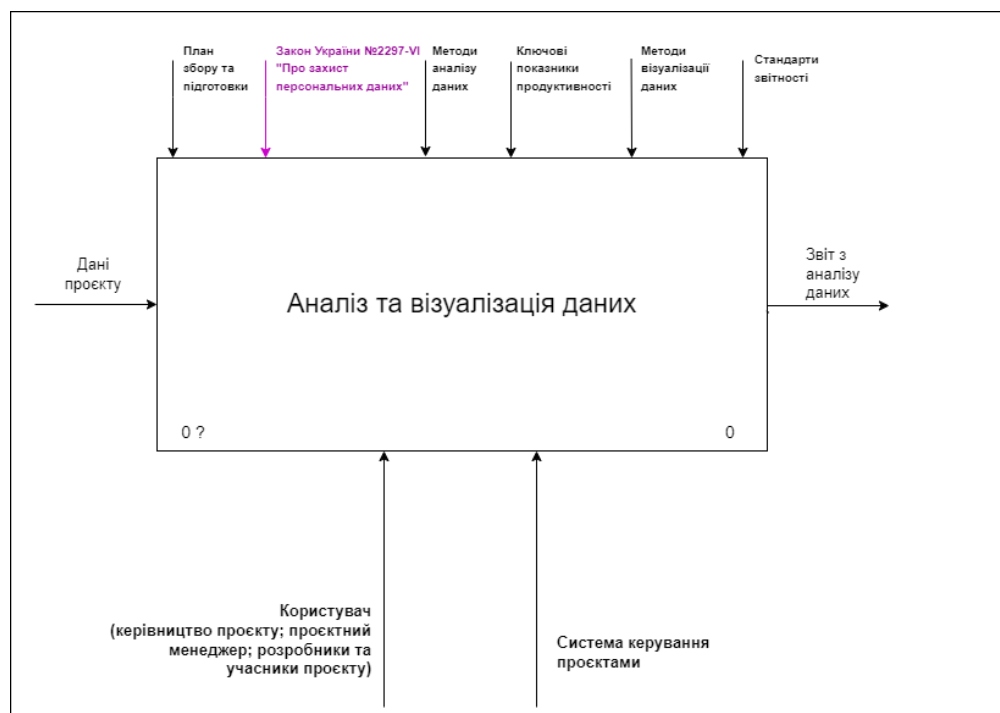
Рисунок 2.6 – Діаграма IDEF0, вузол A-0 (загальний блок)
