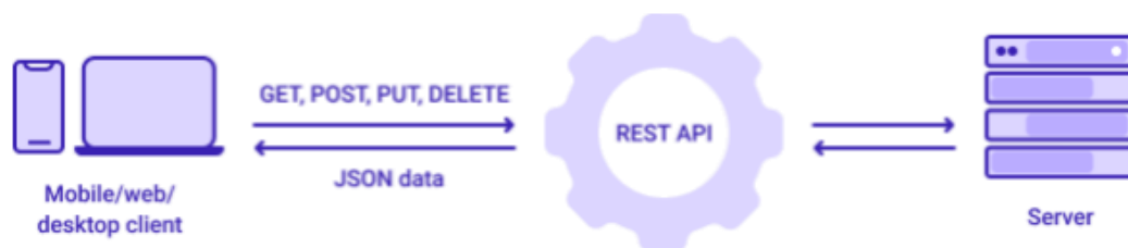
Рисунок 3.19 – Принцип роботи моделі RESTful API
