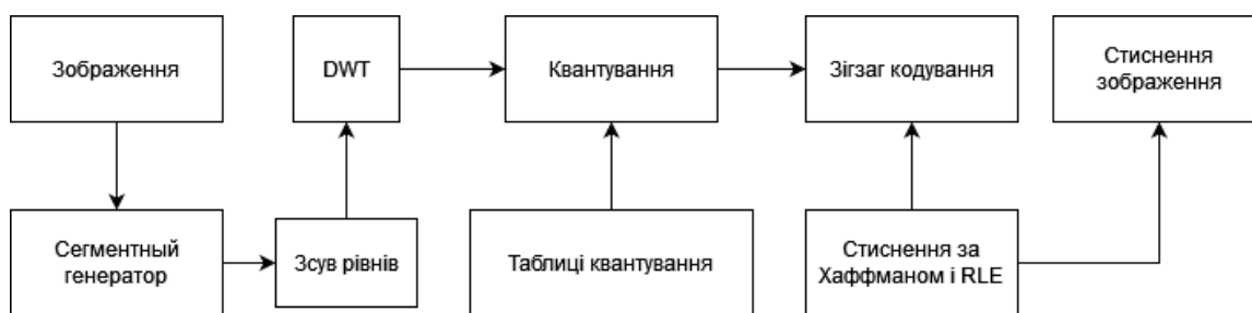
Рисунок 2.10– Схема алгоритму стиснення зображень JPEG2000
