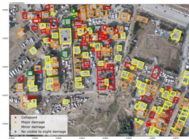
Рисунок 2.8 – Приклад використання техніки object detection для виявлення будинків з різним ступенем пошкодження
