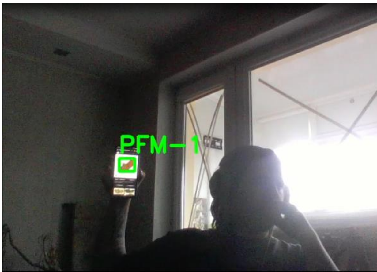
Рисунок 3.34 – Перевірка роботи нейронної мережі використовуючи веб-камеру з низькою роздільною здатністю картинки
