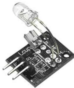
Рисунок 2.1 – IR-сенсор серцебиття KY-039
