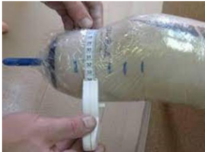
Рисунок 1.9 – Зняття мірок для виготовлення гільзи
